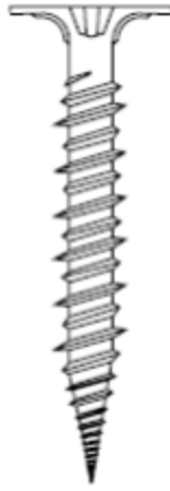
Figure 6 - Vis AQUAPANEL® TTPC
